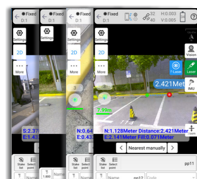
Levantamiento y Replanteo Visual con Láser
