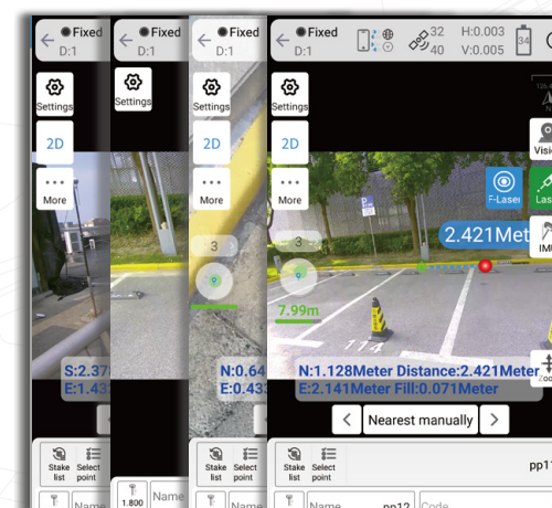
Levantamiento y replanteo visual con láser
